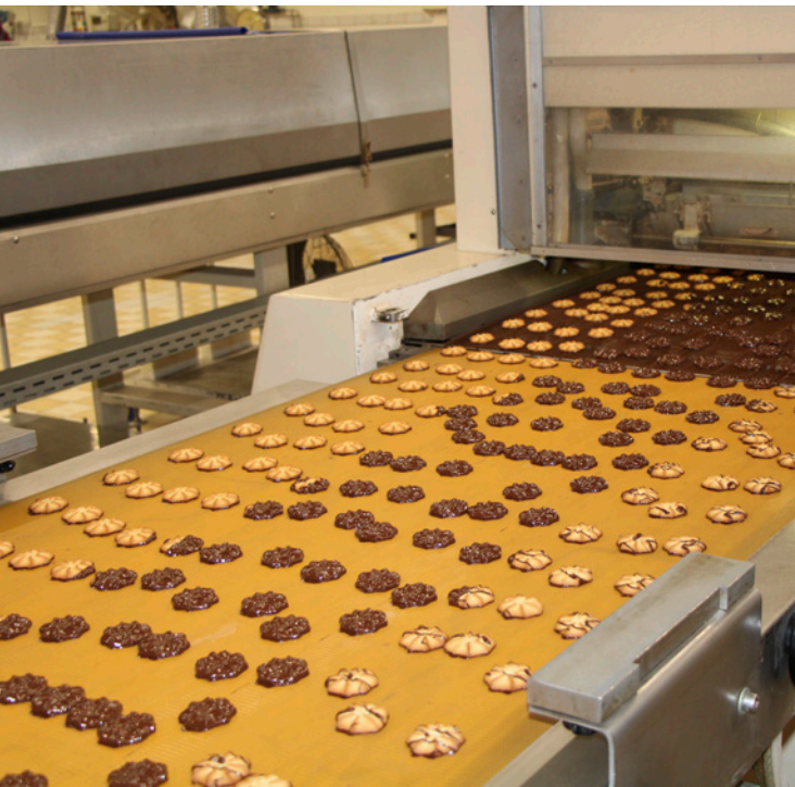
Rationelle Veredelung von Gebäck im Durchlaufverfahren. Rechts: Station für die Datenerfassung im Produktionsbereich.
